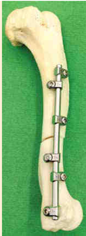
2. ÁBRA. Karcsonmodell medialis oldalára felhelyezett SoPLC-rendszer
