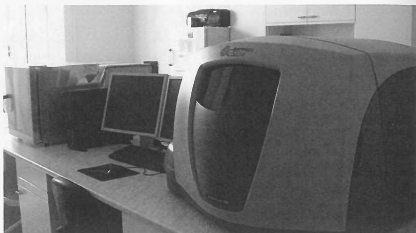
2. ábra. A halak többféle sperma- és vérparaméterének meghatározására alkalmas „áramlásos citométer”
