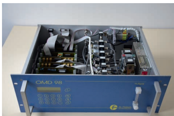
Figure 7. The electronic nose – OMD 98 from Dr. Födösch Umweltmesstechnik AG
